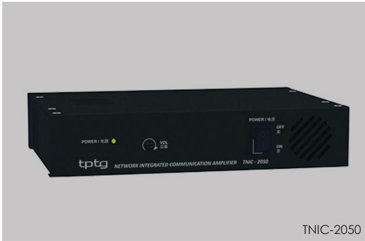
TNIC-2050 IP网络输出终端内置双通道50W的D类功放，专为定阻扬声器设计，能提供高品质的背景音乐及业务公共广播。每个通道都有一个独立的IP地址，能各自接收和解码IP音频流，并能通过TNPS-11 IP网络呼叫站或TNPP-10 IP网络呼叫话筒进行寻呼及播报。
